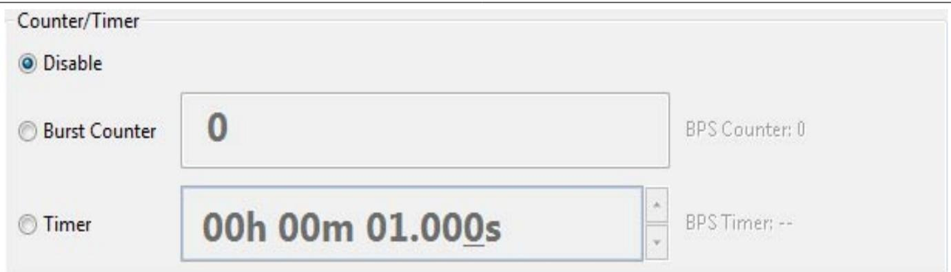
Bild 19 – Einstellen eines Burst-/ Pulszählers bzw. einer definierten Testzeit
