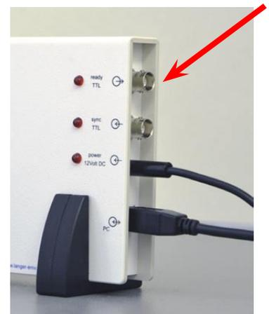
Bild 10 - Anschlüsse BNC für externe Triggerung
