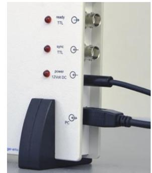
Bild 4 – Anschluss für Steckernetzteil und USB
